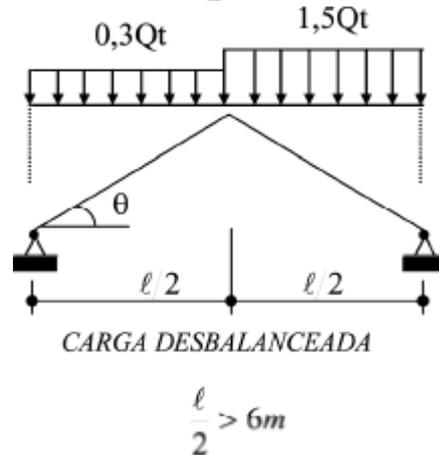
e) Para los techos curvos, dependiendo de la relación  $h/l$ , deberán investigarse los esfuerzos internos para las condiciones de cargas balanceada y desbalanceada, que se indica a continuación:
